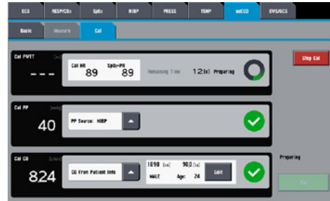
Affichage visuel du paramètre qui est à l'origine de l'échec de l'étalonnage.
