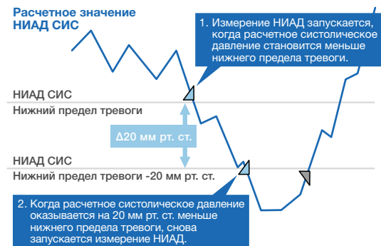
Аналогично происходит, когда расчетное систолическое давление становится выше верхнего предела тревоги для систолического давления.
