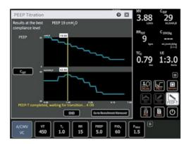
L'application Manœuvre de recrutement peut être utilisée pour effectuer automatiquement une manœuvre de recrutement alvéolaire en utilisant la technique de l'augmentation progressive
